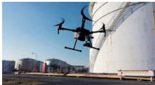
ドローンによる石油タンクの点検の様子
